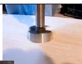
9. Bohre im oberen Drittel in einer der breiteren Seitenwände mit dem Forstnerbohrer ( $\varnothing$  45 mm) ein Loch.
