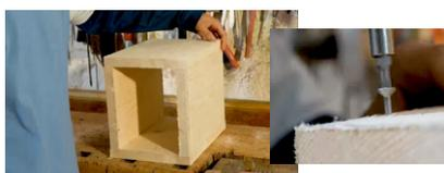
3. Stelle die 4 Seitenwände an der langen Kante so zusammen, dass du einen Quader erhältst.
